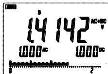
Рисунок 2-12 Измерение переменного + постоянного тока
