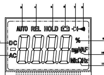
7. Индикатор измерения диода;
