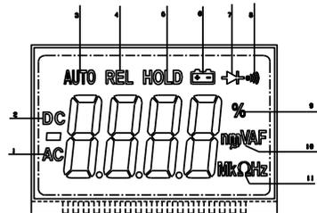
7. Индикатор измерения диода;
