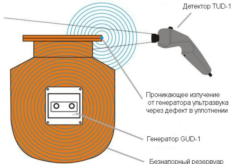
Принцип обнаружения негерметичности с помощью генератора и детектора ультразвука.
