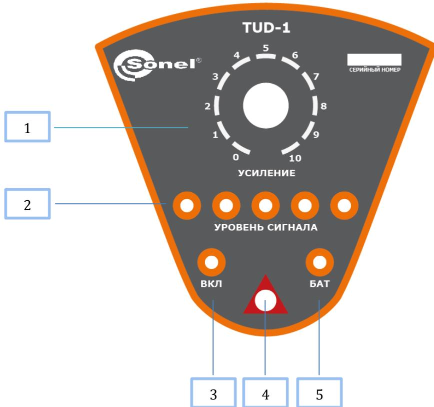
**[1]** – ручка **УСИЛЕНИЯ** для регулировки коэффициента усиления чувствительности входного сигнала.
