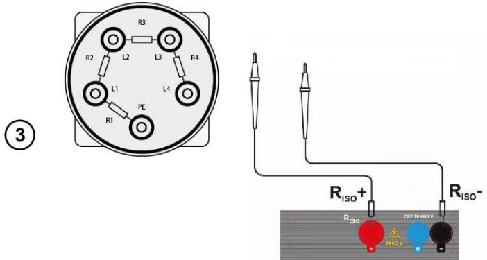
Подключите измерительные провода к разъёмам СК-1.
