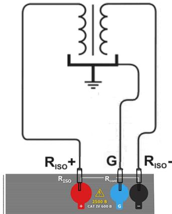
При измерении сопротивления между жилой кабеля и экраном, влияние поверхностных токов (особое влияние оказывают при сложных погодных условиях) устраняют соединением кусочком металлической фольги, навитого на изоляцию измеряемой жилы, с разъёмом **G**.
