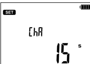
Следующее нажатие  $\rightarrow$  вызывает переход к установке интервала времени **ChA** для снятия характеристики  $R_{ISO}$ .
