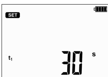
С помощью клавиш  $\uparrow$  и  $\downarrow$  задайте значение  $t_1$ , затем нажимая клавишу  $\rightarrow$  перейдите к установке  $t_2$ , а потом  $t_3$ .
