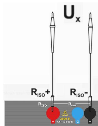
Подключить прибор к источнику напряжения.
