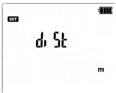
Клавишами **←** и **→** перейдите к следующему экрану настройки функции **diSt** установки единицы измерения длины.
