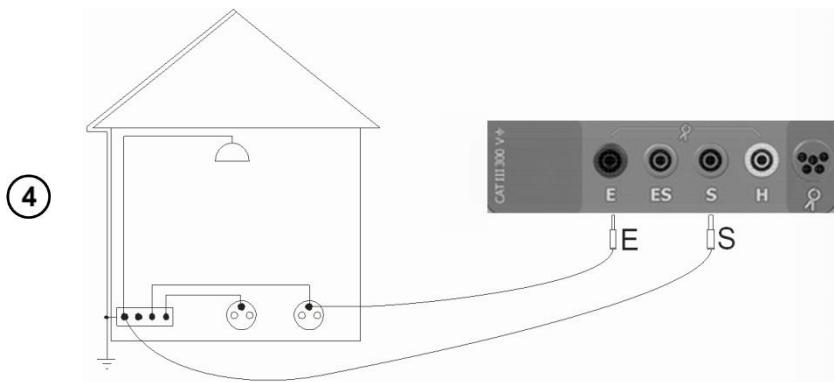
Подключите измерительные провода согласно рисунку.
