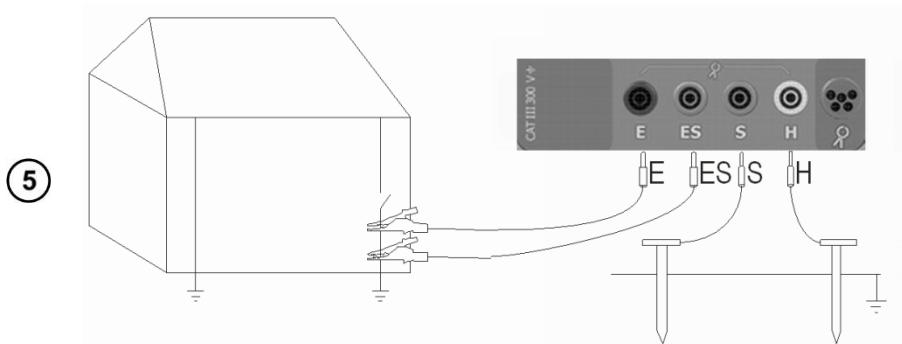
Подключить измерительные провода согласно рисунку.
