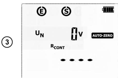
Постоянное отображение надписи **AUTO-ZERO** (не мигает), свидетельствует о выполненной калибровке измерительных проводов. В результате получено компенсированное значение с поправкой для измерения  $R_{\text{CONT}}$ . Компенсация также сохраняется после отключения и при включении измерителя (если отображается надпись **AUTO-ZERO**).
