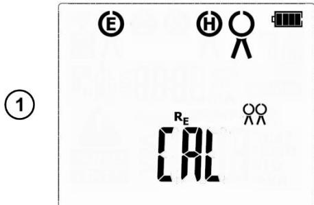
В режимах **3P+Ω** или **ΩΩ** используя клавишу **УСТ/ВЫБ** перейдите к экрану калибровки токоизмерительных клещей.
