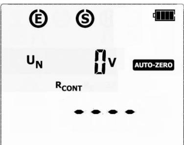
В режиме  $R_{CONT}$  используя клавишу **УСТ/ВЫБ** перейти к экрану автоматического обнуления сопротивления измерительных проводов **AUTO-ZERO**. Мигающая надпись **AUTO-ZERO**, свидетельствующая о готовности выполнения калибровки измерительных проводов.
