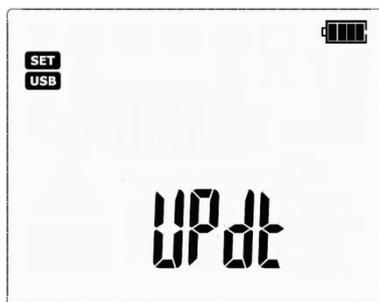
Клавишами **←** и **→** перейдите к следующему экрану настройки функции **UPdt** для обновления программного обеспечения измерителя.
