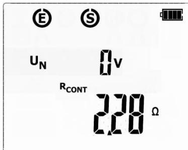
После завершения измерения считайте с экрана результат и значение напряжения помехи.
