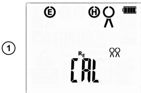
В режимах **3P+** или используя клавишу **УСТ/ВЫБ** перейдите к экрану калибровки токоизмерительных клещей.
