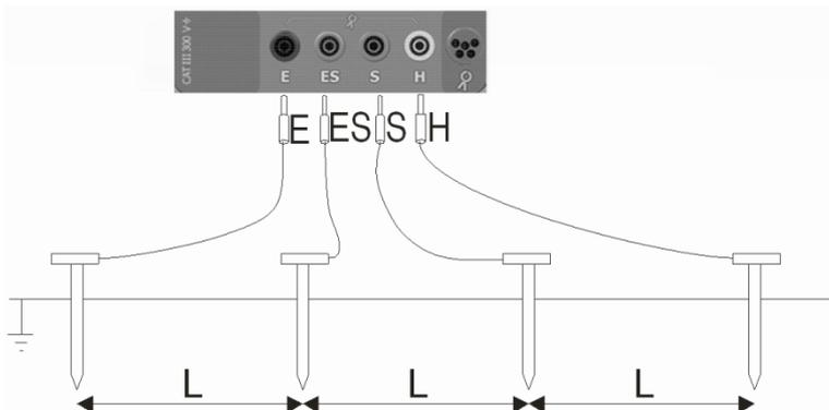
Подключить измерительные провода согласно рисунку.
