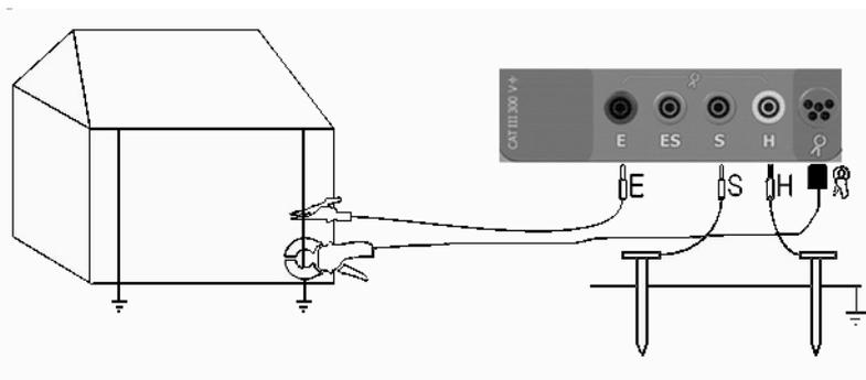
Подключить измерительные провода согласно рисунку.
