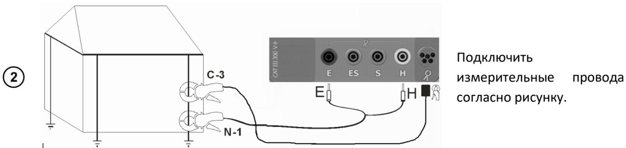
Подключить измерительные провода согласно рисунку.
