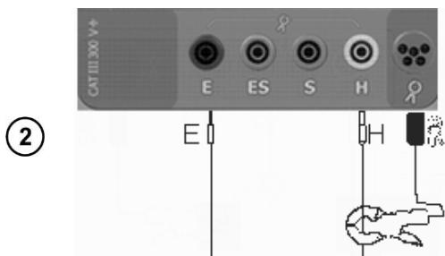
Замкните проводом разъёмы измерителя **E** и **H**, обхватите клещами этот провод.
