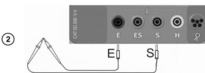
Подключить измерительные провода согласно рисунку.
