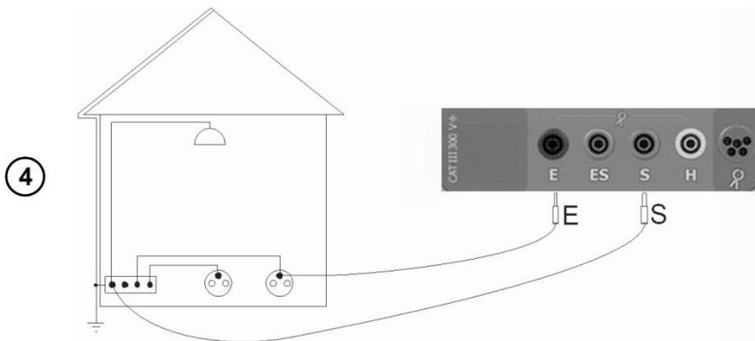
Подключите измерительные провода согласно рисунку.
