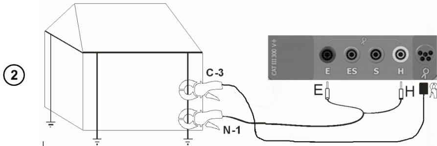
Подключить измерительные провода согласно рисунку.
