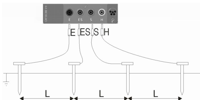
Подключить измерительные провода согласно рисунку.
