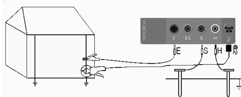
Подключить измерительные провода согласно рисунку.
