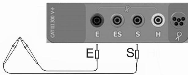
Замкните между собой провода, подключенные к разъёмам **E** и **S**.
