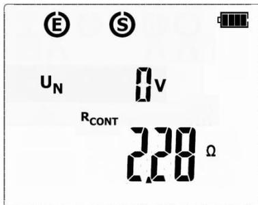
После завершения измерения считайте с экрана результат и значение напряжения помехи.
