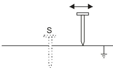
Повторите измерения несколько раз перемещая на несколько метров вдоль прямой потенциальный зонд: удаляя и приближая его к проверяемому заземлению.
