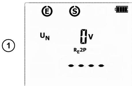
В режимах измерения **2P**, **3P**, **4P**, **3P+клещи**, **R<sub>cont</sub>**, **ρ**, до нажатия клавиши «СТАРТ», прибор контролирует напряжение на измерительных клеммах (между разъёмом E и остальными разъёмами), а значение напряжения помехи отображается на дисплее.
