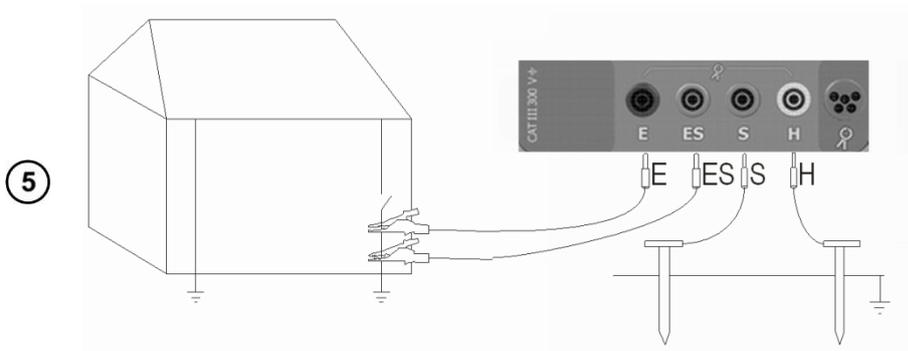
Подключить измерительные провода согласно рисунку.
