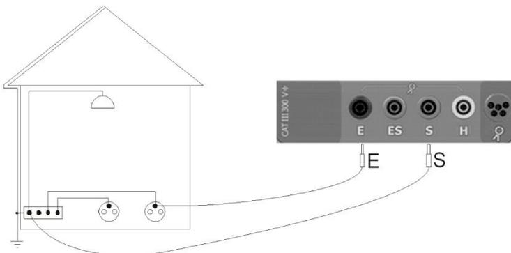
Подключить измерительные провода согласно рисунку.
