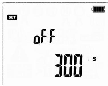
Клавишами **←** и **→** перейдите к следующему экрану настройки функции **oFF** автоматического отключения прибора.
