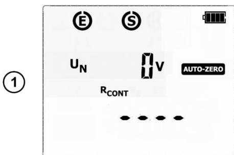
В режиме  $R_{\text{CONT}}$  используя клавишу **УСТ/ВЫБ** перейти к экрану автоматического обнуления сопротивления измерительных проводов **AUTO-ZERO**.
