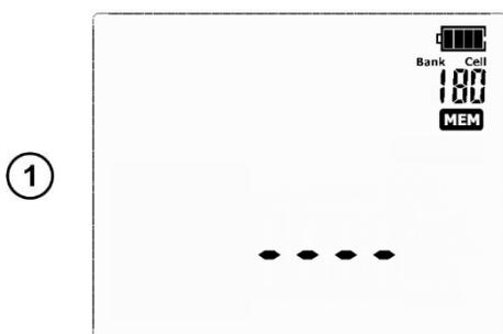
После выполнения измерения нажмите клавишу **ВВОД**. Измеритель переключится в режим записи в память.
