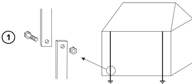
Тестируемое заземляющее устройство отсоединить от схемы заземления объекта.
