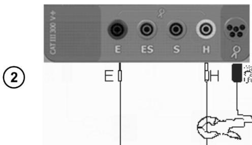
Замкните проводом разъемы измерителя **E** и **H**, обхватите клещами этот провод.
