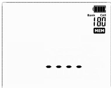
После выполнения измерения нажмите клавишу **ВВОД**. Измеритель переключится в режим записи в память.
