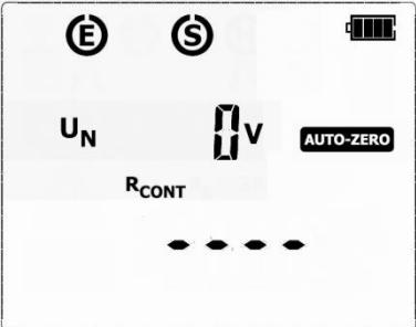
Постоянное отображение надписи **AUTO-ZERO** (не мигает), свидетельствует о выполненной калибровке измерительных проводов. В результате получено компенсированное значение с поправкой для измерения  $R_{CONT}$ . Компенсация также сохраняется после отключения и при включении измерителя (если отображается надпись **AUTO-ZERO**).
