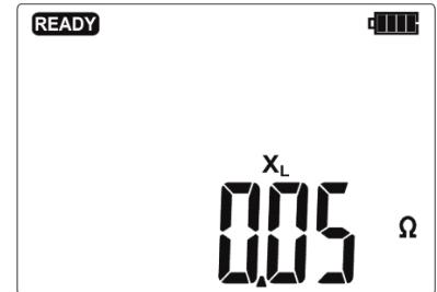
$X_L$  реактивное сопротивление петли короткого замыкания.
