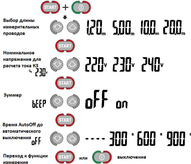
Установите параметры согласно следующему алгоритму.
