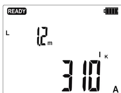
Значение тока короткого замыкания  $I_k$  и отдельных составляющих полного сопротивления  $Z_S$  ( $R$ ,  $X_L$ ) можно увидеть, нажимая клавиши стрелок вверх или вниз для показаний, отображаемых в обратном порядке.
