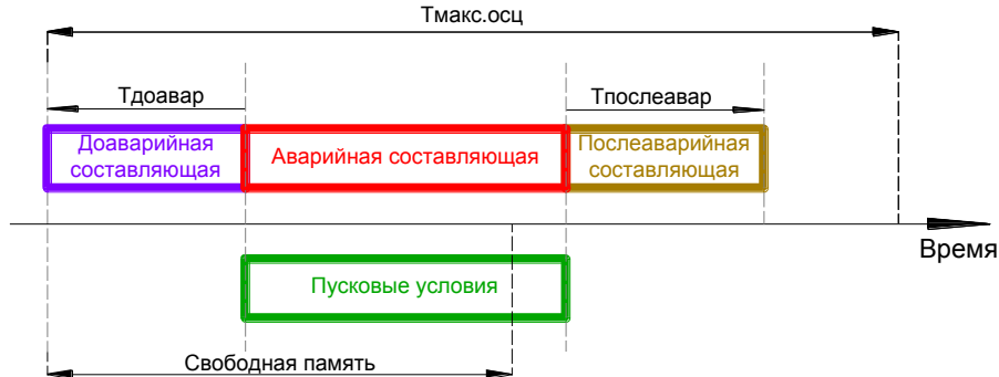
Рисунок 34 – Случай потери осциллограммы при значении настройки «Общие»–«Реж.записи»=«Останов.»
