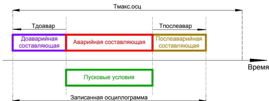
Рисунок 31 – Значение настройки «Осциллограф»–«Общие»–«Тмакс.осц.» превышает суммарную длительность составляющих осциллограммы
