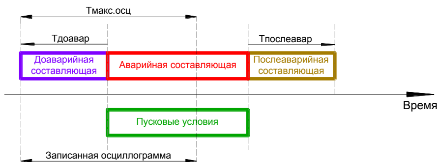
Рисунок 32 – Значение настройки «Осциллограф»–«Общие»–«Тмакс.осц.» меньше суммарной длительности составляющих осциллограммы
