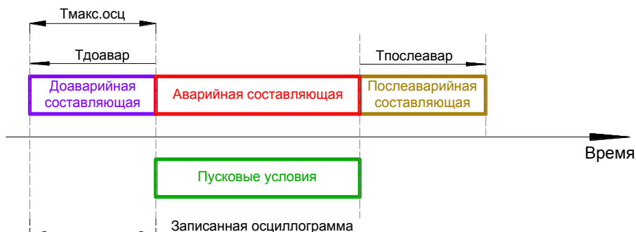
Рисунок 33 – Значение настройки «Осциллограф»–«Общие»–«Тмакс.осц.» равно настройке «Осциллограф»–«Общие»–«Тдоавар.»
