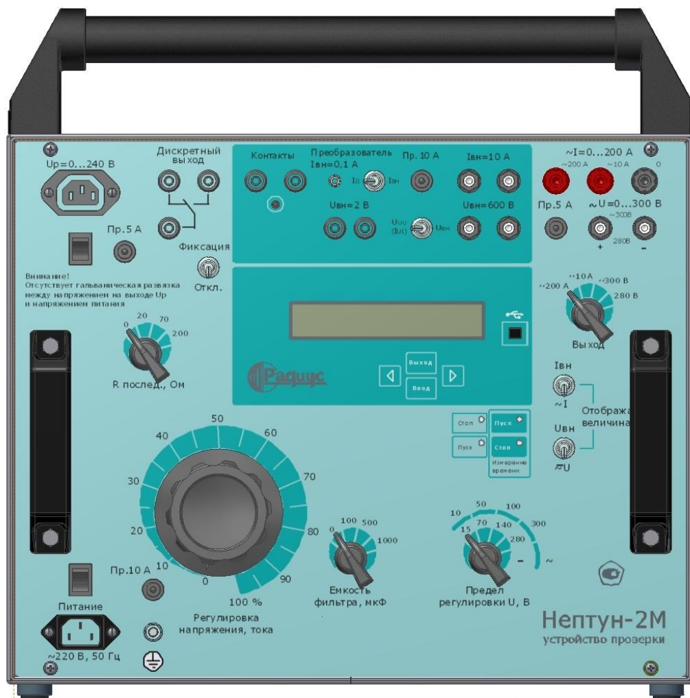
Рисунок 1 – Панель управления устройства «Нептун-2М»
