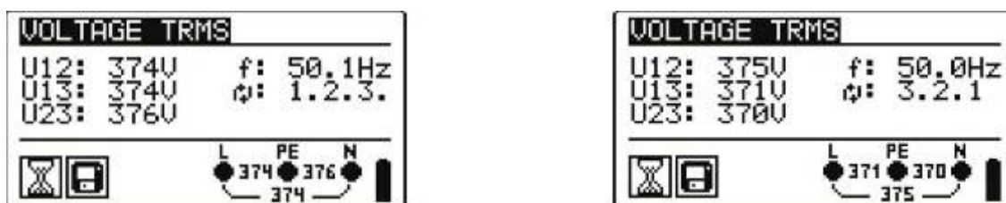
Рисунок 5.17: Примеры измерения напряжения в трехфазной цепи
