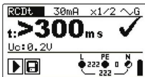
Рисунок 5.4: Пример результатов измерения времени отключения
