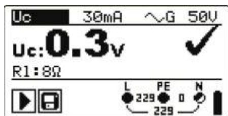
Рисунок 5.3: Пример результатов измерений напряжения прикосновения
