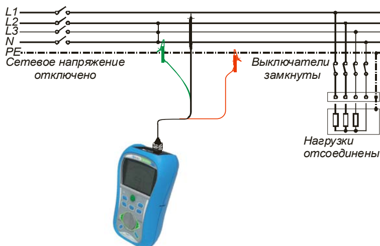
Рисунок 5.3: Подключение 3-проводного измерительного кабеля
