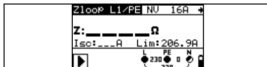
Рисунок 5.17: Полное сопротивление короткозамкнутого контура
