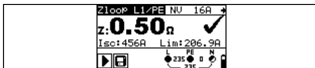
Рисунок 5.19: Примеры результатов измерения импеданса контура
