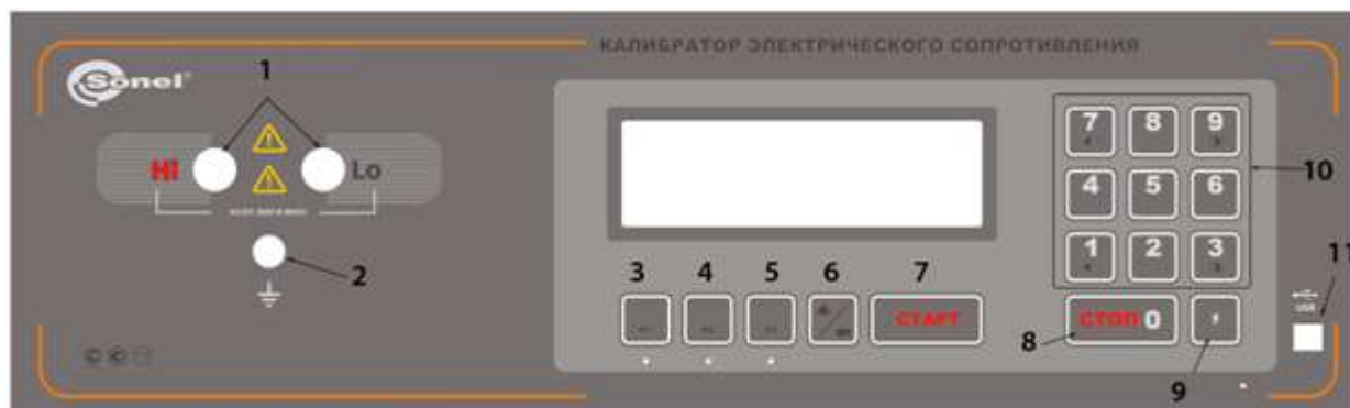
Рис.1. Лицевая панель калибратора
