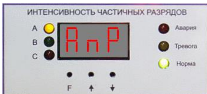
Рисунок 33 Ввод амплитуды импульсов генератора
