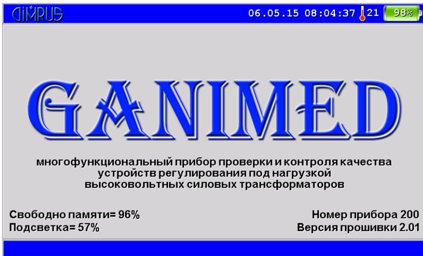
В верхней части экрана отображена информация о текущем времени прибора, температуре внутри прибора и проценте заряда аккумулятора. В нижней части экрана – процент свободного места в памяти прибора, яркость подсветки, заводской номер и версия программного обеспечения. Для выхода в основное меню прибора нажмите любую кнопку на клавиатуре.
