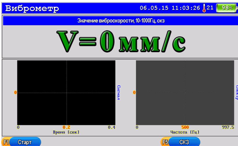
В верхней части экрана отображается интегральный параметр выбранного сигнала (пик, скз или размах в зависимости от выбранных параметров регистрации).
