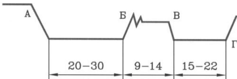
Время на осциллограмме дано в мс. Контакты, работающие на замыкание, имеют вибрацию. Допускается следующая вибрация: в начале участка Б В – до 3 мс; на участке В Г – до 3 мс; после точки Г – 4 мс.
