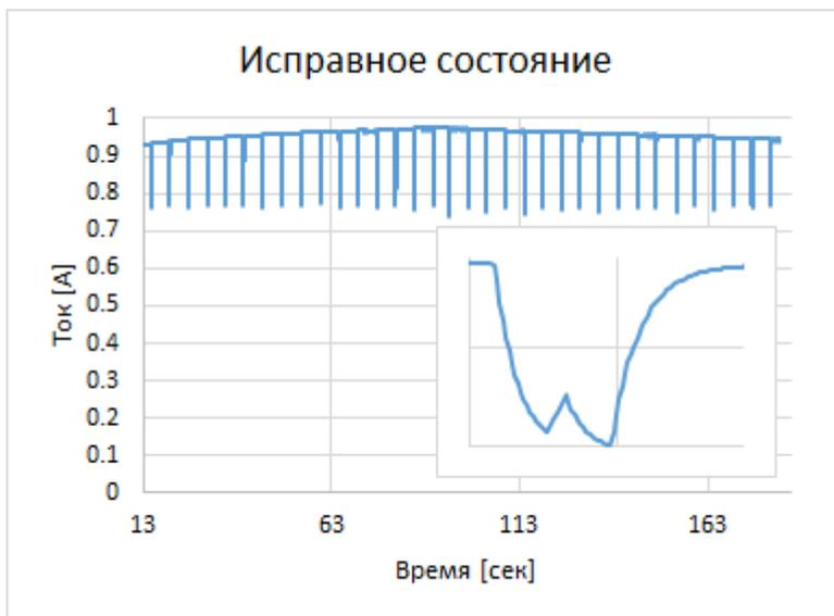
Осциллограмма тока фазы трансформатора, снятая с помощью метода DRM. Измерения проведены по всем положениям РПН, при работе в прямом и обратном направления движения избирателя.
