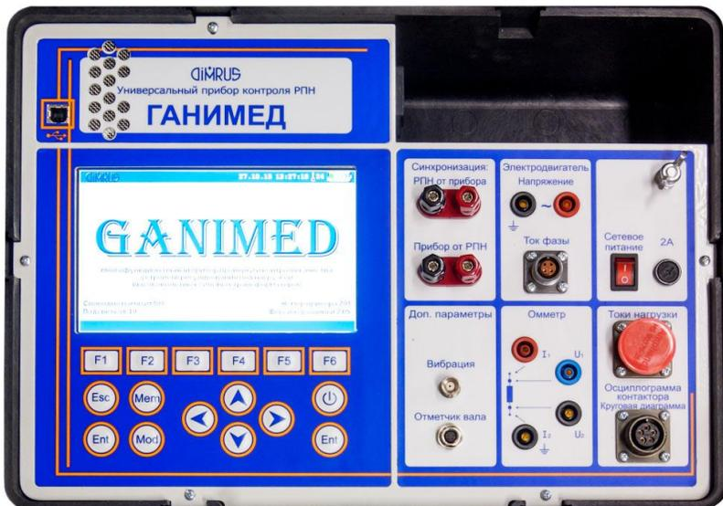
Синхронизация “РПН от прибора” – выход реле сухой контакт (5А), при запуске регистрации данных контакты реле замыкаются;
