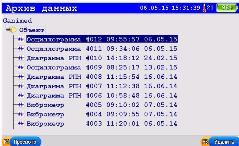
Структура отображается в виде дерева. Вверху – прибор “Ganimed”. К нему “привязаны” Объекты, на которых происходит измерение. Текущий Объект обведен пунктирной рамкой. Все сохраненные замеры приписываются к нему. Список замеров на Объекте может быть развернут, тогда слева от Объекта отображается “Минус в квадратике”, или свернут – отображается “Плюсом в квадратике”. Свернуть объект можно кнопкой “←”, развернуть – кнопкой “→”.
