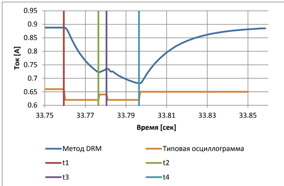
Анализ осциллограммы для определения временных характеристик переключения контактов контактора РПН базируется на очевидных свойствах полученной кривой. Эта кривая является кусочно-непрерывной, состоящей из пяти разных интервалов. Процесс переключения контактов контактора РПН начинается в момент, когда ток уменьшается по экспоненциальному закону (участок t1 – t2), и завершается в момент минимального значения тока, после которого ток увеличивается по экспоненциальному закону (участок t3 – t4).
