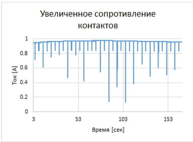
Импульсы коммутационного тока в некоторых положениях РПН, как при прямом, так и при обратном движении избирателя, имеют увеличенную амплитуду.
