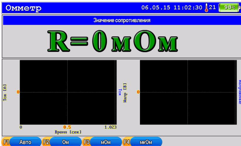
В верхней части экрана отображается измеренное значение сопротивления.
