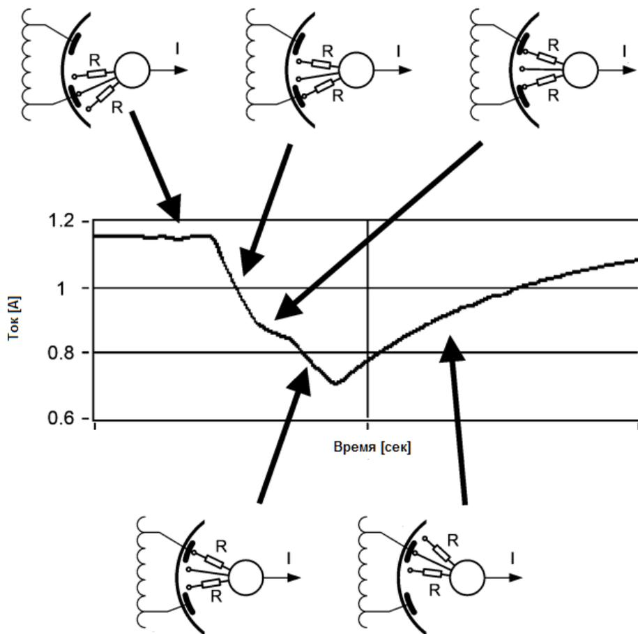
Когда переходный резистор R подключен в цепь, испытательный ток, протекающий через обмотки трансформатора, начинает уменьшаться. В среднем положении оба резистора параллельны в измерительной цепи. Общее переходное сопротивление становится равным  $\frac{1}{2} R$ , что вызывает более медленное падение тока (рост тока также возможен, в зависимости от длительности включения переходных резисторов и параметров схемы). После того, резисторы выключаются из цепи и испытательный ток стабилизируется.
