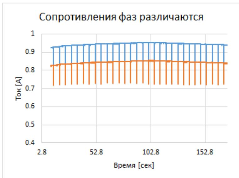
Из рисунка осциллограммы хорошо видно, что токи в фазах трансформатора значительно различаются. При этом броски тока имеют одинаковую амплитуду.
