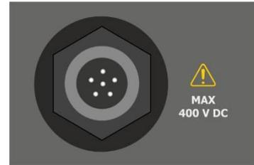
Разъём для подключение 4-х контактного измерительного зонда
