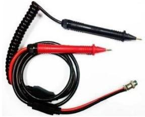
4-х контактный измерительный зонд
