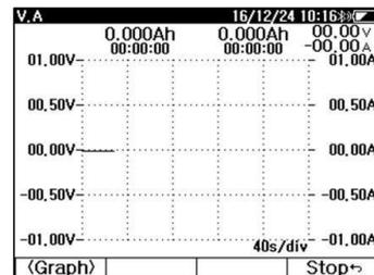
Переключение между экраном графиков и экраном данных осуществляется с помощью кнопки **<Graph>/<Data>** во время записи. На экране "График" записываемые данные отображаются в виде графика, а на экране "Данные" - измеренные значения вместо графика.
