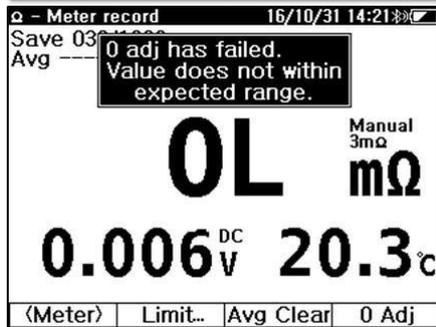
Если зонд неисправен или неправильно вставлен в регулировочную линейку, то значение будет выходить за пределы ожидаемого диапазона, и регулировка будет отменена.
