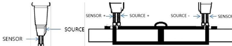
**Параллельный тип наконечника:** Выступающая сторона является источником, а другая сторона - датчиком.
