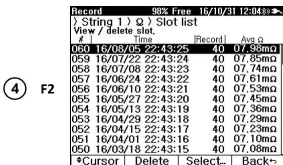
Выберите **Select...**. На экране появятся слоты строчных измерений, содержащие время измерения, номер записи и среднее значение сопротивления.
