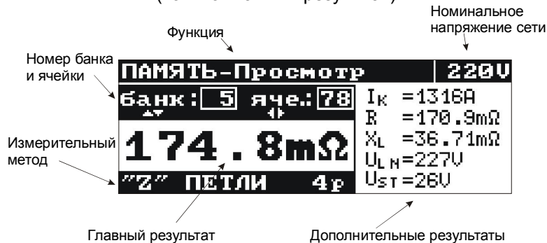
Рис.4. Вид экрана в режиме измерения полного сопротивления петли короткого замыкания (только главный результат)
