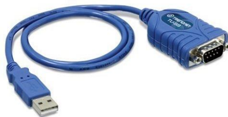
Рис. 28 Адаптер интерфейса конвертор USB / последовательный порт TU-S9
