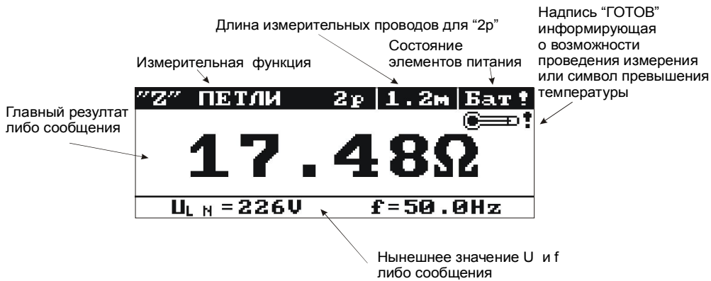
Рис.4. Вид экрана в режиме измерения полного сопротивления петли короткого замыкания (только главный результат)
