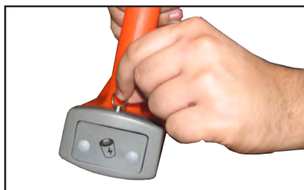
а) Выдвинуть фиксатор, освободить батарейный отсек
