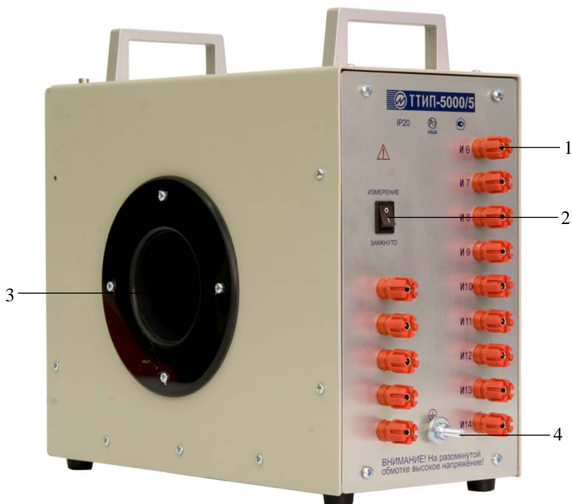
Рис. 2.1. Внешний вид ТТИП-5000/5:
